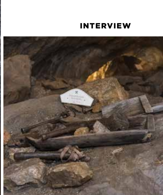
Nachgestellte Feuerstelle zur Veranschaulichung der Feuersetzung, einer der ältesten Methoden des Erzabbaus.
